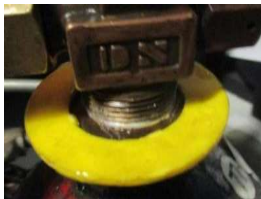
氧氣鋼瓶水壓測試環 5 年有效
