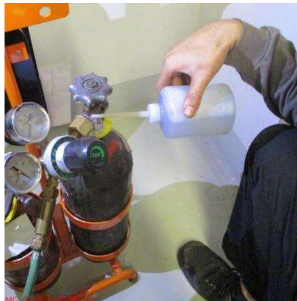
肥皂水檢查氣體管線及各接頭 無漏氣
