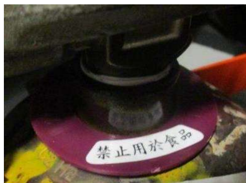
乙炔鋼瓶水壓測試環 5 年有效
